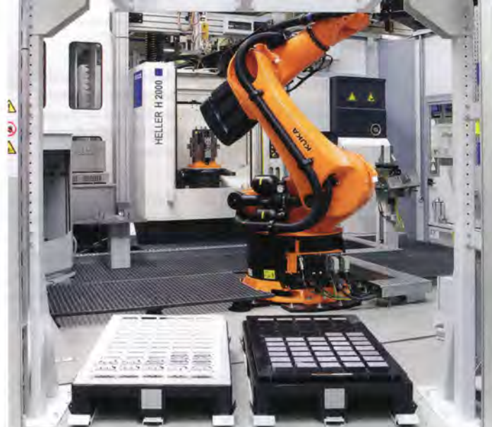
Eine von zwei Materialstationen für jeweils zwei Eurokunststoffpaletten für Roh- und Fertigteile.
