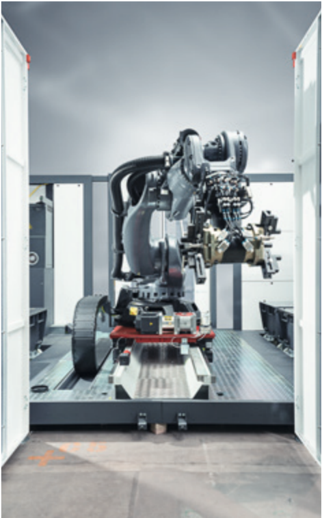
Roboter und Werkzeugmaschinen sind gut zu erreichen, z. B. für Spannittel- und Werkzeugwechsel
